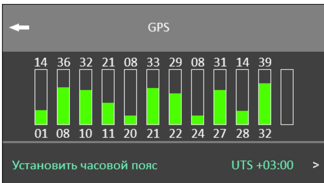
На экране визуально отображена информация о количестве используемых спутников и уровне сигнала от каждого из них.
