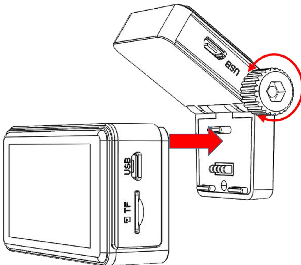
3. Ослабьте винт на кронштейне и отрегулируйте угол наклона камеры. Рекомендуется сначала немного опустить объектив, чтобы убедиться, что вид камеры параллелен горизонтальной поверхности. Рекомендация: соотношение земля / небо составляет приблизительно 6/4. После регулировки затяните винт на кронштейне.
