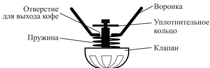
Когда вы устанавливаете кофейник на платформу с подогревом, крышка кофейника приподнимает клапан. Вместе с клапаном поднимается уплотнительное кольцо внутри воронки и открывает отверстие для выхода кофе. Когда вы вынимаете кофейник, пружина выталкивает клапан вниз и уплотнительное кольцо плотно закрывает отверстие для выхода кофе. Таким образом, когда вы вынимаете кофейник, подача кофе приостанавливается, а когда устанавливаете кофейник обратно, подача кофе возобновляется.
