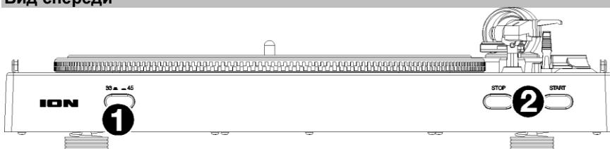
1. **Переключатель 33 / 45** – позволяет выбрать соответствующее пластинке число оборотов в минуту.
