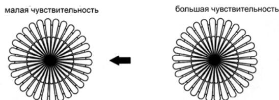
При выборе места установки необходимо исключить из зоны обнаружения датчика объекты, которые могут приводить к его ошибочным срабатываниям. Для этого необходимо избегать установки датчика вблизи зон температурного возмущения (кондиционер, центральное отопление) и вентиляторов. Чем ближе температура окружающей среды к 36 °С, тем хуже чувствительность прибора. Туман или дождь могут существенно повлиять на область обнаружения датчика. Верхняя одежда так же влияет на чувствительность датчика.
