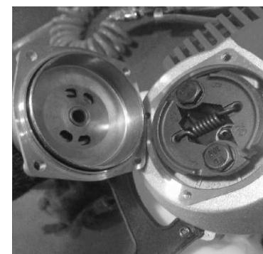
Установите штангу в отверстие корпуса сцепления до упора. Убедитесь, что вращение передается с чашки сцепления на приводной вал штанги. Закрепите штангу в корпусе сцепления с помощью винта.
