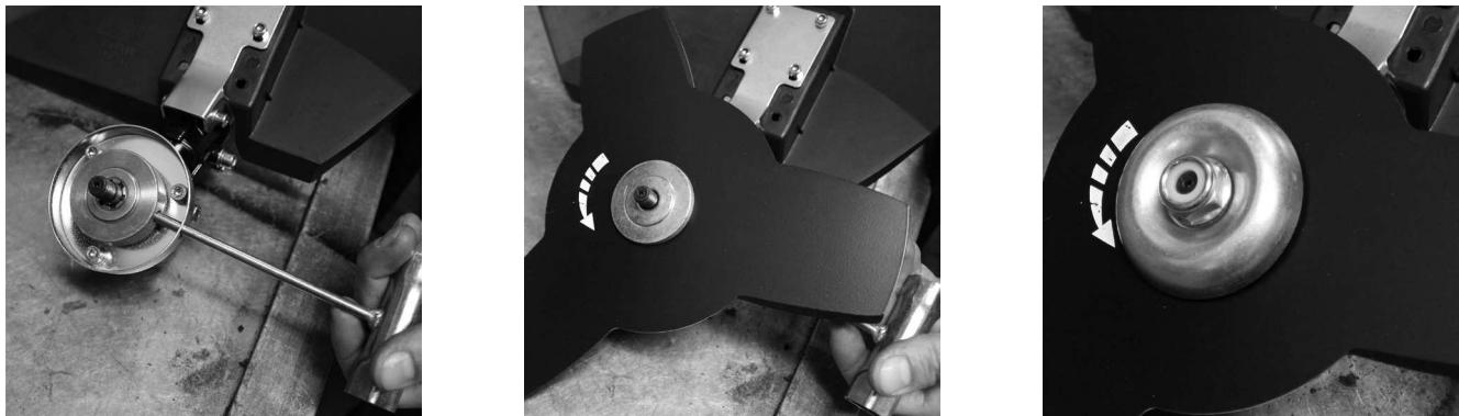
Крепление режущего диска: совместите отверстие в ступице вала с отверстием в чашке редуктора.
