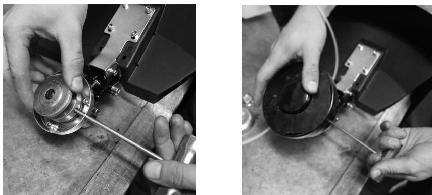
Крепление головки с леской: Совместите отверстие в ступице вала с отверстием в чашке редуктора. Вставьте металлический стопорный стержень в отверстие в чашке редуктора и в отверстие в ступице вала. Открутите гайку крепления со ступицы изделия. Снимите чашку с вала, оставив ступицу. Удерживая стержень, закрутите катушку против часовой стрелки до упора.
