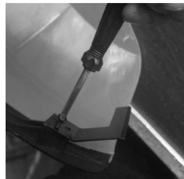
Установите трансмиссионную штангу в корпус редуктора до упора. Убедитесь, что приводной вал передает вращение на шпиндель редуктора. Закрепите штангу в редукторе болтом.
